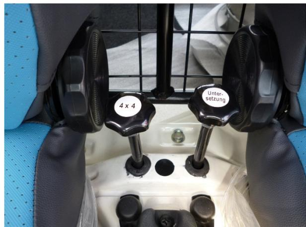
**Achtung – Untersezung funktioniert nur mit eingeschaltetem Allrad !**
