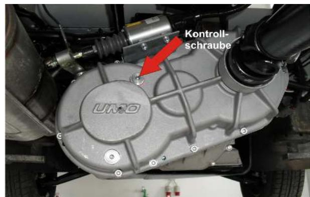
**Achtung!** Im Ausgleichsbehälter darf sich kein Öl bei Stillstand befinden - der Ausgleichsbehälter wurde aus Sicherheitsgründen eingebaut, da sich sehr viel Öl im Getriebe bewegt und sich bei Wärme ausdehnt.
