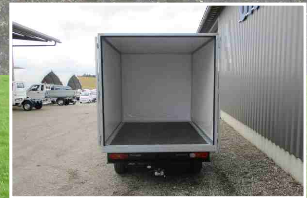
Ladeboden mit Holzboden und Zurrösen
