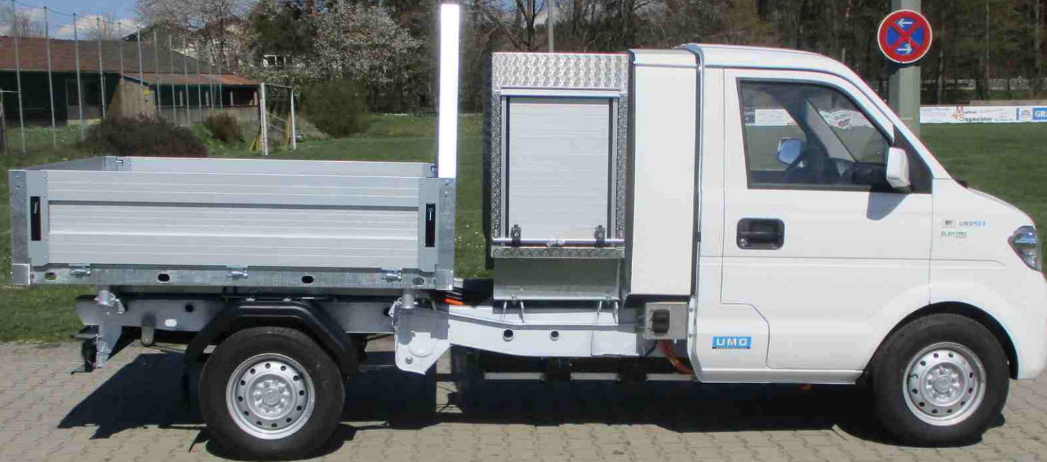
K03 Basis-Fahrzeug mit Kabinenverlängerung optional mit Rolladenbox
