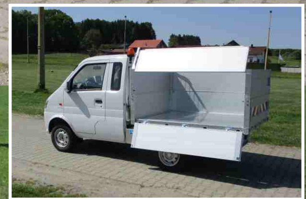
Bordwanderhöhung nach oben abklappbar
