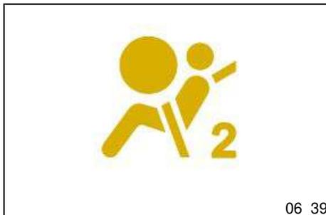
Je nach Ausstattung leuchtet diese Kontrolllampe, wenn der Beifahrerairbag durch Betätigung des entsprechenden Schalters deaktiviert wird.
