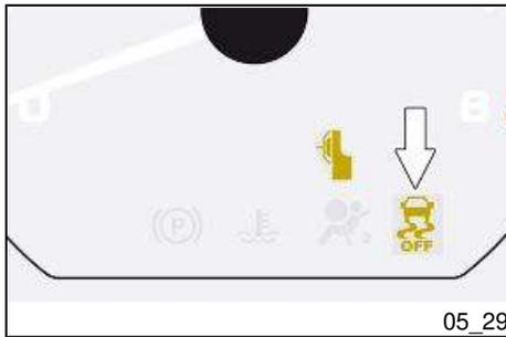
Sicherstellen, dass das «ESC»-System (Elektronische Stabilitätskontrolle) aktiv ist und die entsprechende Kontrolllampe auf der Instrumententafel AUSGESCHALTET ist.
