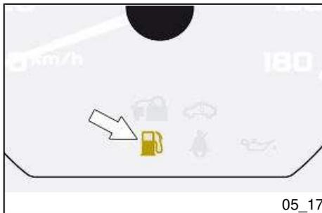
Das Aufleuchten der entsprechenden Kontrolllampe auf der Instrumententafel zeigt an, dass die Kraftstoffreserve im Tank erreicht wurde. Den Kraftstofftank rechtzeitig füllen.
