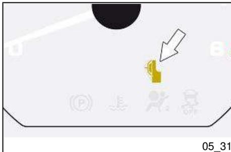
Das Kupplungspedal gedrückt halten und sicherstellen, dass die Kontrolllampe Anlasssperrlampe auf der Instrumententafel AUSGESCHALTET ist.
