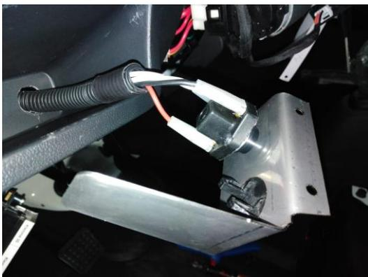
Kabel durchführen und an Schalter bzw Taster anschließen.
