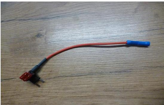
7. Versorgungsspannung rotes Kabel mit Sicherung 10A an KL 30 (Dauerplus z.B. Hupensicherung) im Sicherungskasten anstecken. Weißes Kabel an Klemme 31 (Masse) verschrauben.
