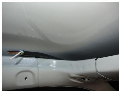
3. Kabel im Querrahmen bis Mitte Dach verlegen.
