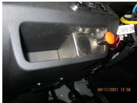
2. Versorgungsspannung rotes Kabel an KL30 (Dauerplus z.B. Hupensicherung) im Sicherungskasten anstecken. Weißes Kabel an Klemme 31 (Masse) verschrauben. Sicherungskastendeckel für Kabel ausnehmen ca. 10x3mm
