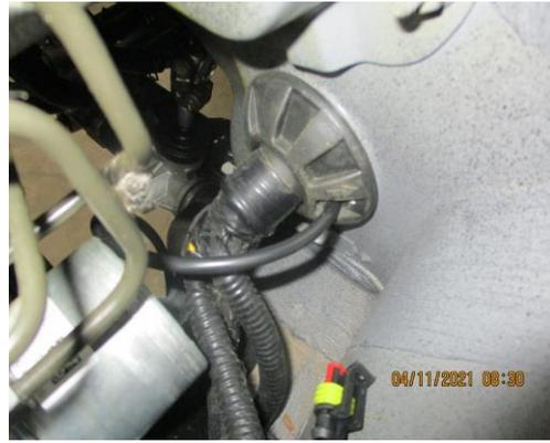
4. Kabel am Kabelbaum nach hinten verlegen, am Rahmen entlang. Kantenschutz unter ORIGINAL Kabelbaum anbringen.
