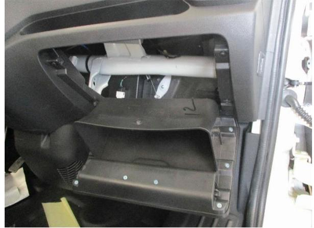
Kabel für Bedienteil links vom Kabelbaum durch vorhandene Gummitülle führen.
