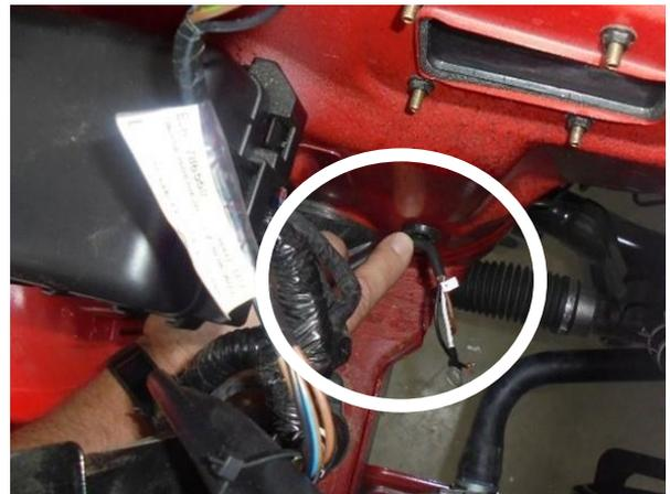
Kabel über Vorderachse an Karosserie am Kabelbaum bis zur Batterie verlegen.
